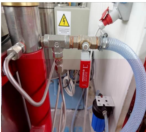
Rys. 3 - 4. Widok tylnej strony autoklawu (zaworu spustowego wody oraz zaworu ciśnienia resztkowego).
