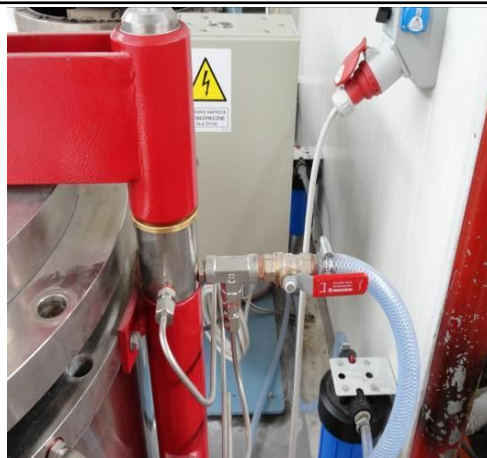
Rys. 3 - 4. Widok tylnej strony autoklawu (zaworu spustowego wody oraz zaworu ciśnienia resztkowego).
