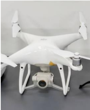
Dron z kamerą to bezzałogowy statek powietrzny, sterowany zdalnie przez operatora.
