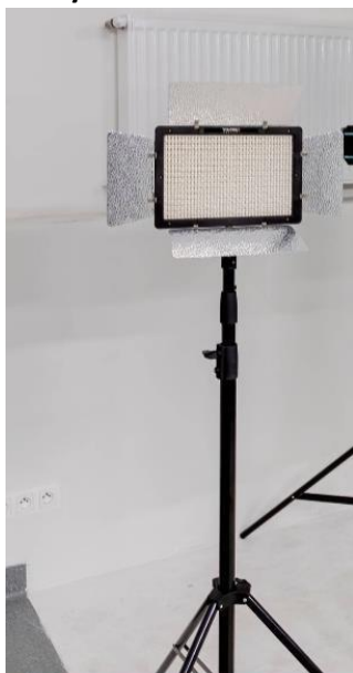
Lampy studyjne światła ciągłego , które umożliwiają doświetlenie planu zdjęciowego oraz nagrań wideo. Panel ledowy jest wyposażony we wrota.
